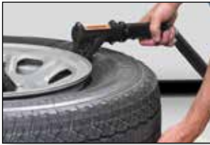
Air-Schock-Befüllung - Schickt einen großen Luftstoß zur undichten Stelle.
